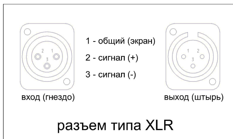
Рис.2 Функциональное назначение контактов разъемов линейного входа и линейного выхода
